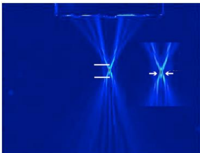
Рис.1 Теневая карта профиля луча интенсивного ультразвука; 95% энергии ультразвука = доставлено в фокусную точку объемом почти 1,5 мм 3 (голубой X). (по Уайта В.М., Мэйкин И.Р., Слэйтон М.Х. и др. Избирательная чрезкожная доставка энергии в мягкие ткани свиньи с помощью интенсивного ультразвука. Lasers Surg Med 2008; 40:68; публикуется с разрешения владельца)
